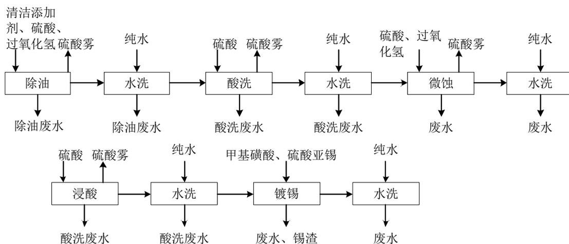
图 4.1.10 镀锡试验线工艺流程及产排污环节
