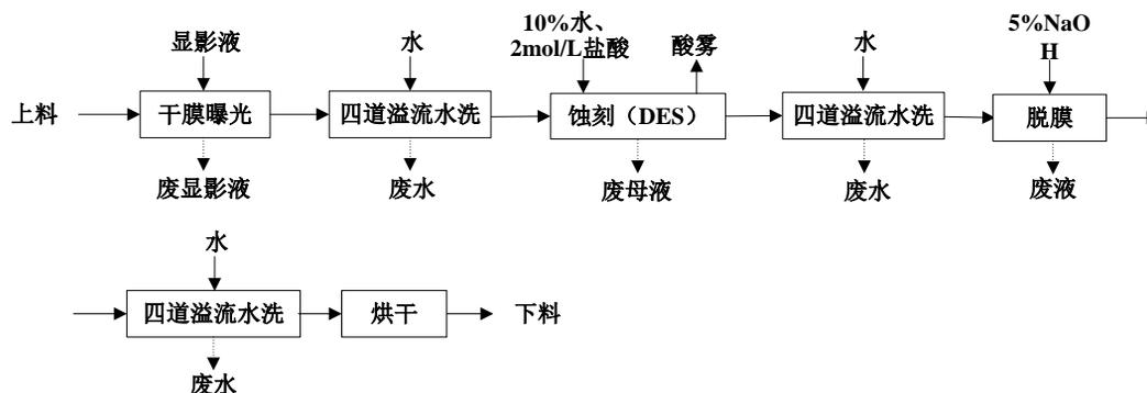
图 4.1.7 蚀刻线（DES）工艺流程及产排污环节
