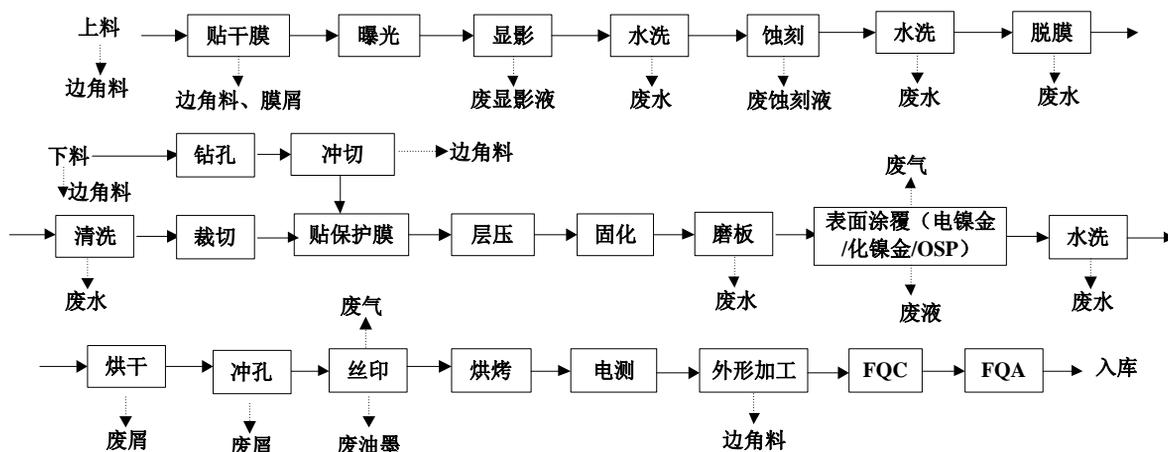
图 4.1.1 单面板生产工艺流程及产污环节
