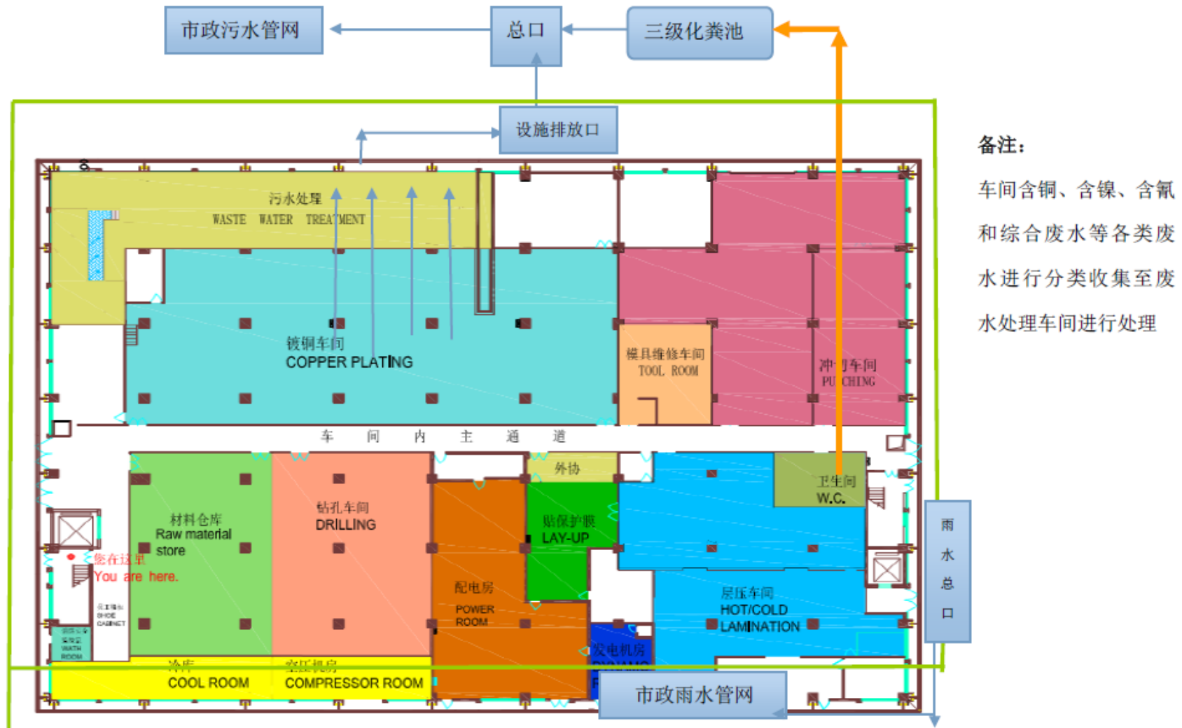
厂区雨污管网图
